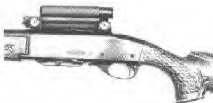
*AIMPOINT Electronic Mark III postavljen na lovački karabin uz korišćenje donjih Suhl nosača klasičnog ON tako da se na jednom karabini u postojeće mehaničke nišane mogu upotrebljavati i različiti optički nišani*
